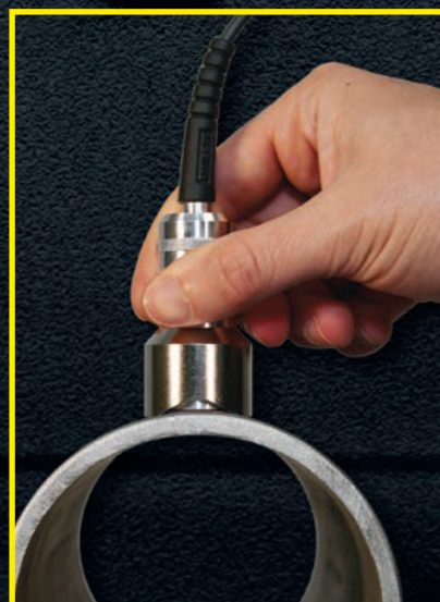
PosiTector SPG OS felületprofilmérő szonda ívelt felületekhez
